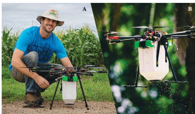
Figura 1. Drone utilizado para liberação de ácaros (A). Ácaros Neoseiulus californicus liberados em plantações de milho na Austrália (B).
