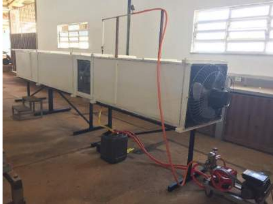
Figura 1. Túnel de vento construído para avaliação da deriva no Laboratório de Mecanização Agrícola da Universidade Federal de Viçosa Campus Rio Paranaíba - MG.
