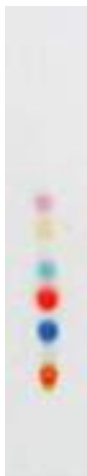
Figura 9. Figura ilustrativa de uma placa de cromatografia em camada fina, contendo seis manchas, que teoricamente correspondem a seis compostos diferentes. A revelação das manchas foi feita com solução de p -anisaldeído em etanol contendo ácido sulfúrico.
