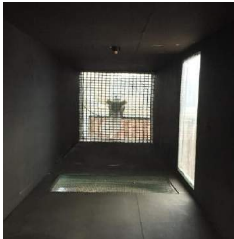
Figura 2. Detalhe do posicionamento do ventilador, das telas, da comeia, da ponta de pulverização e do depósito para armazenar a calda pulverizada no interior do túnel de vento.
