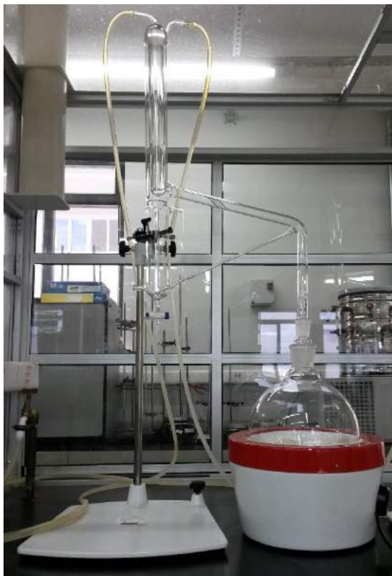
Figura 2. Foto ilustrativa de um aparato de Clevenger modificado para a realização de hidrodestilação.
